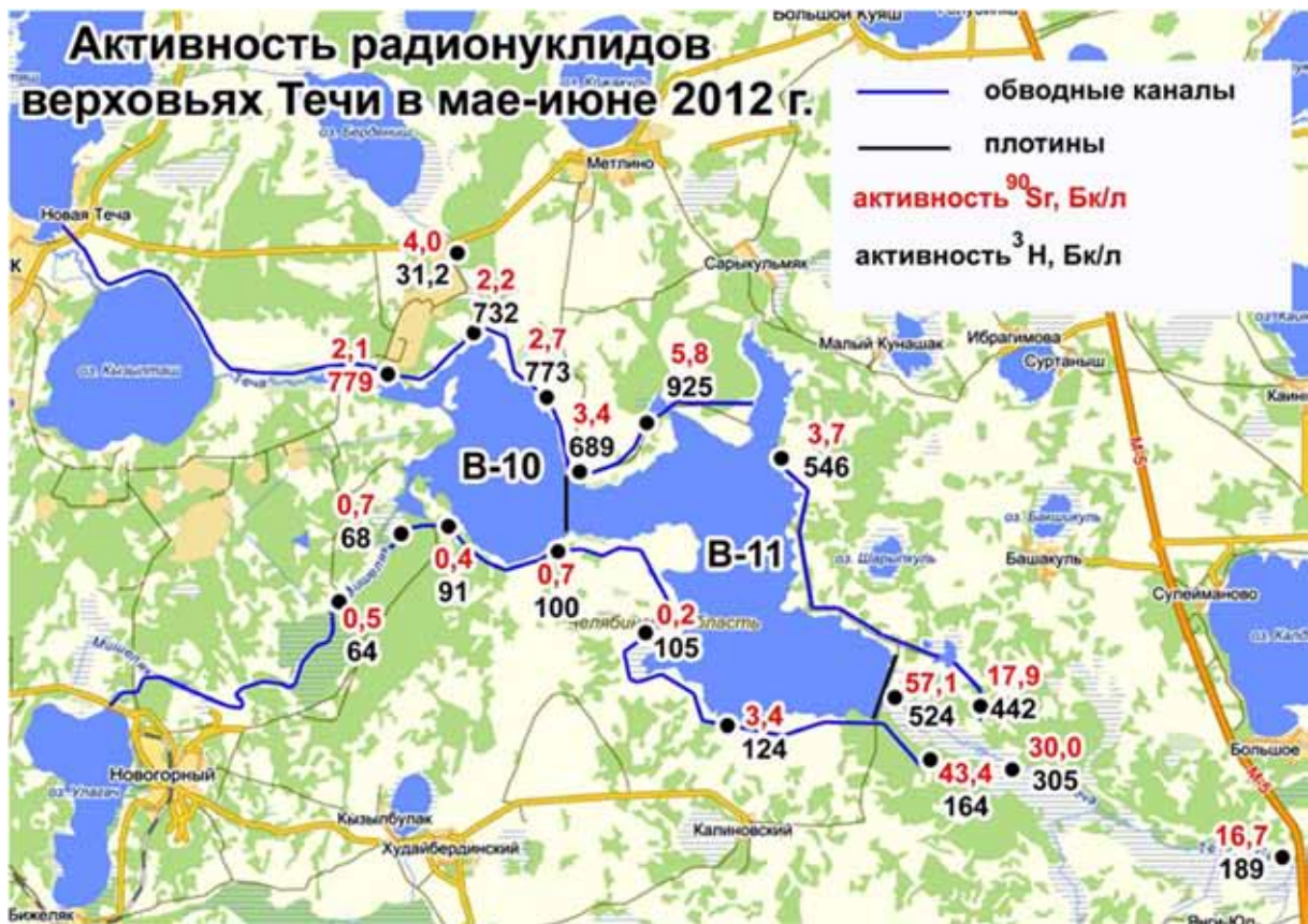
Рисунок 1 – Удельная активность ^{90}\text{Sr} и ^3\text{H} в пробах воды в обводных каналах и реке Теча
