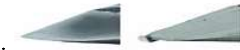
Рис. 10 – Игла под увеличением в 370 раз до и после инъекции
