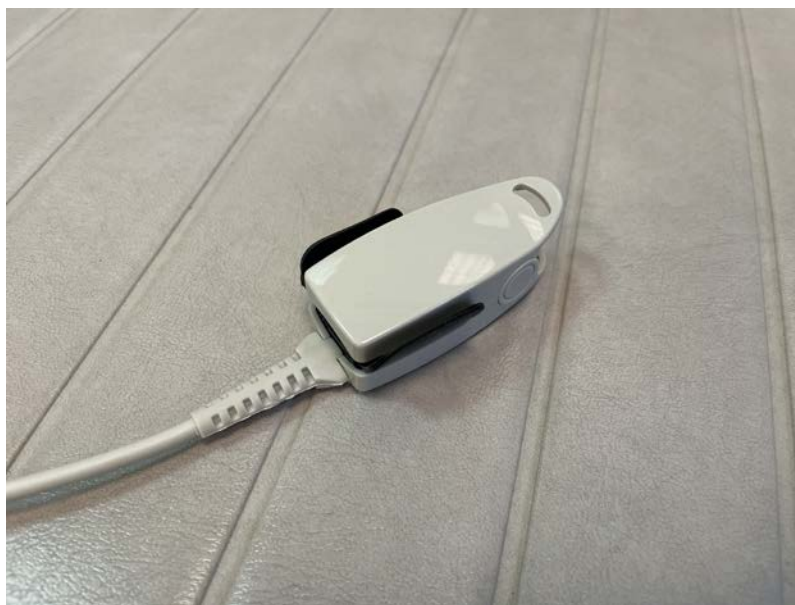
Рис. 2 Датчик пульсоксиметра для мониторинга кислородной сатурации у взрослых
