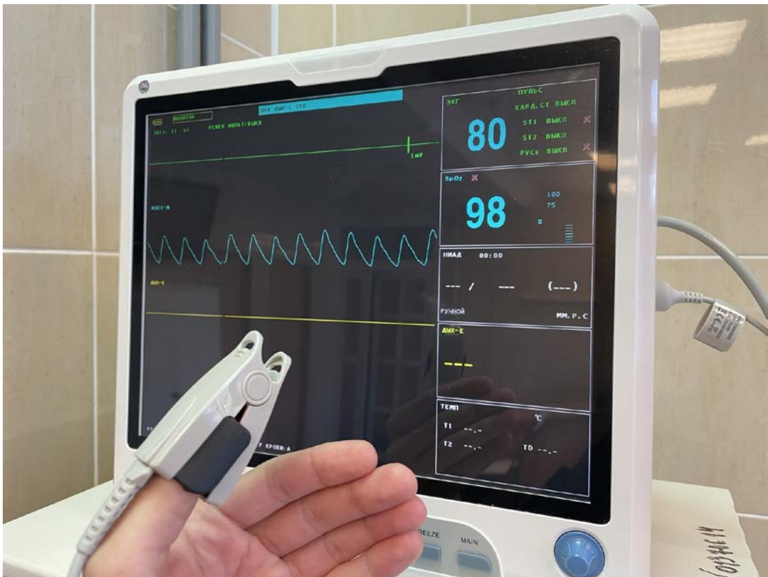
Рис. 5 Система комплексного мониторинга CONTEC CMS9000 с модулем для проведения пульсоксиметрии
